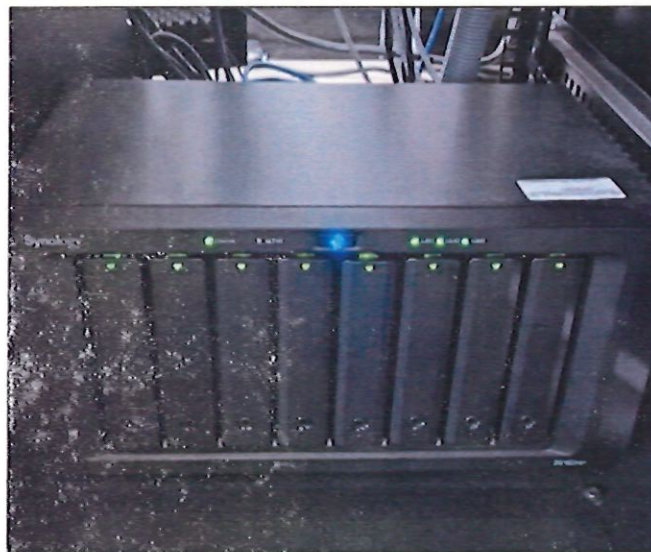
Imagen N° 06: Instalación de servidor NAS synology DS1823xs+, para base de datos de SIGA y SIAF
